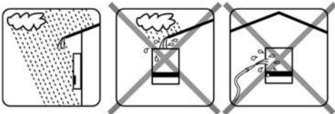
Figura 2.1 Evitare un contatto continuo con acqua
