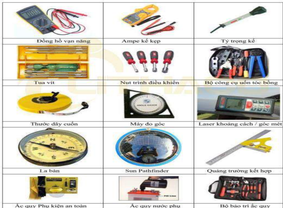
Công cụ và phụ kiện cho O & M và khắc phục sự cố hệ thống microgrid
